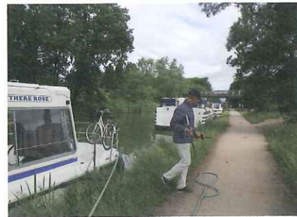
基本的には、禁止区域以外は、運河内のどこに係留してもよい。陸にクリートやボラードがないところでは、こんな具合に、ハンマーで杭を打って、そこに舳を取る
