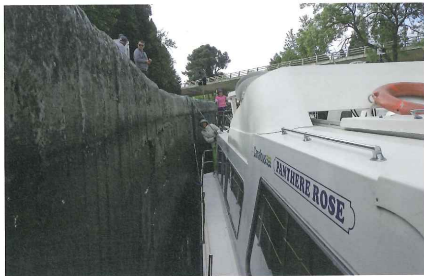
ロック内に水を出し入れする際には、船が動かないように、陸側にロープでつないでおく必要がある。2人だったので、この作業の連続に、少々疲れてしまった
